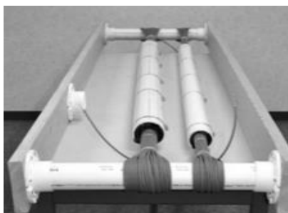
图4.3.3-3 管道中的捆扎电缆温升测试
